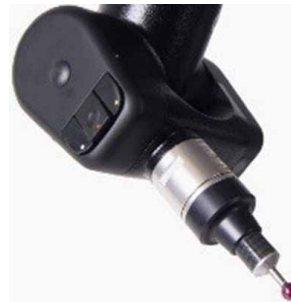
Rys. 1. Głowica dotykowa z końcówką szafirową
