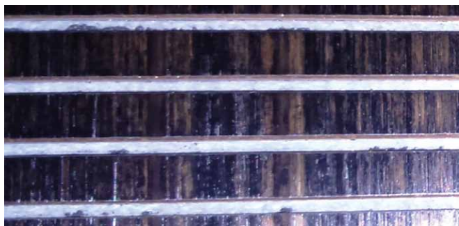
Rys. 24. Obraz komutatora z małymi rysami i łuszczącymi się punktami
