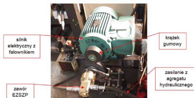
Rys. 9. Zawór EZSZP zabudowany na stanowisku badawczym [5]
