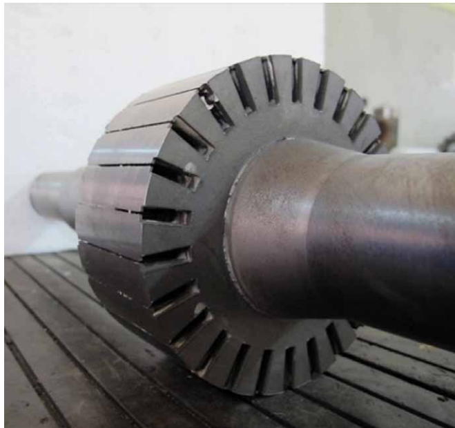
Rys. 1. Model wirnika z wałem bezpośrednio przylegającym do pakietu – wariant 1
