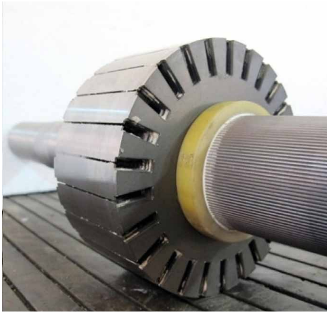
Rys. 2. Model wirnika z wałem osadzonym na tulei niemagnetycznej - wariant 2
