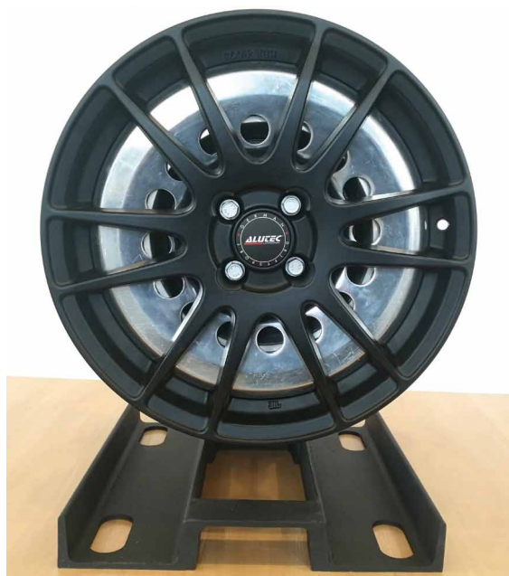
Rys. 1. Wykonany prototyp silnika do zabudowy w kole
