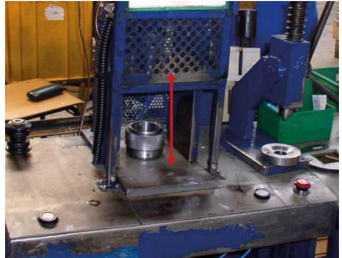
Rys. 2. Urządzenie do pneumatycznego wciskania tulejek
