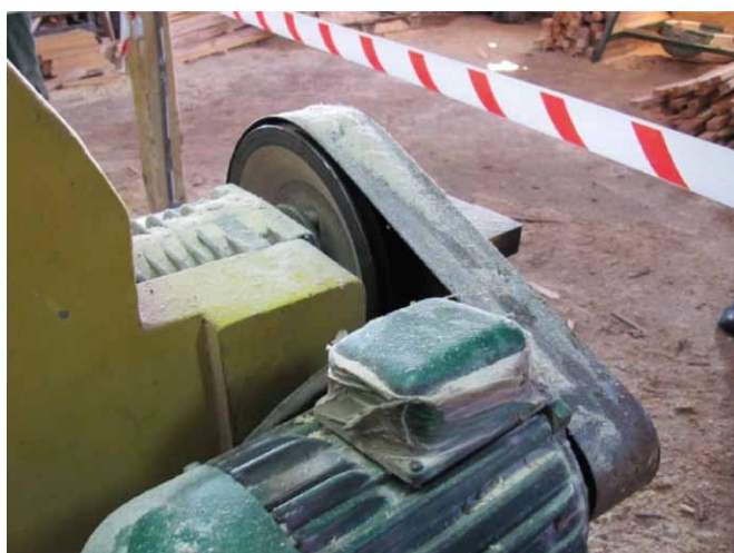
Rys. 6. Osłona elementów napędowych
