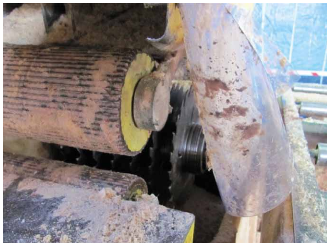
Rys. 5. Osłona boczna wielopięty
