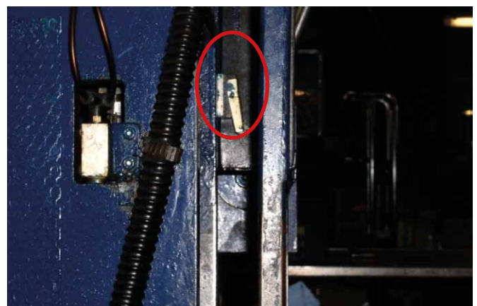
Rys. 4. Element sterujący uruchamiany przez opadającą osłonę przednią
