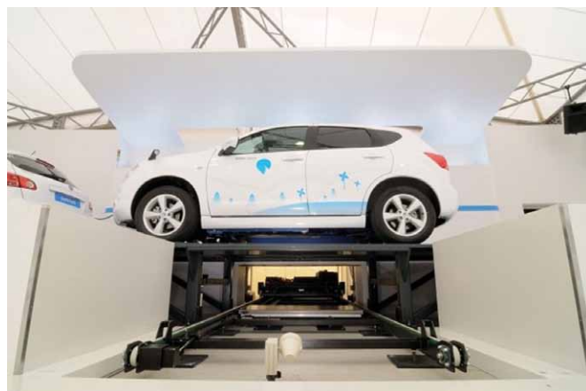
Rys. 6. Stacja szybkiej wymiany baterii akumulatorów [10]
