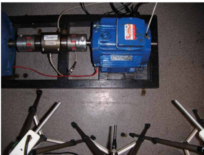
Rys. 2. Rozmieszczenie mikrofonów wokół silnika
