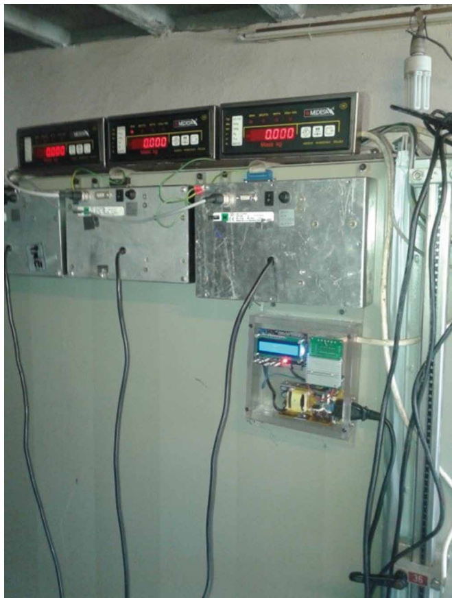
Rys. 2. Widok tunelu aerodynamicznego od strony panelu kontrolnego – widok wyświetlaczy wagi i obrotnicy łopaty
