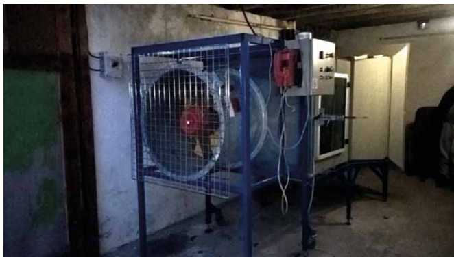
Rys. 1. Widok tunelu aerodynamicznego od strony wentylatora
