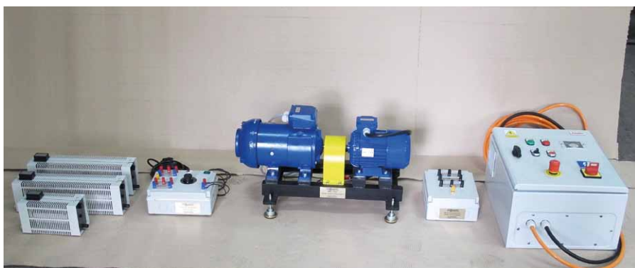
Rys. 4. Zestaw elektromaszynowy do badania prądnicy obcowzbudnej prądu stałego
