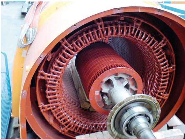
Fot. 1. Nagrzewanie wirnika silnika indukcyjnego w stojanie silnika indukcyjnego o mocy 6,3 MW
