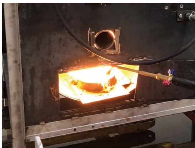
Rys. 6. Pryzma materiału palnego zapalana płomieniem palnika [2]
