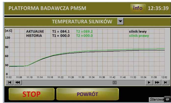
Fot. 11. Trendy temperatur silników
