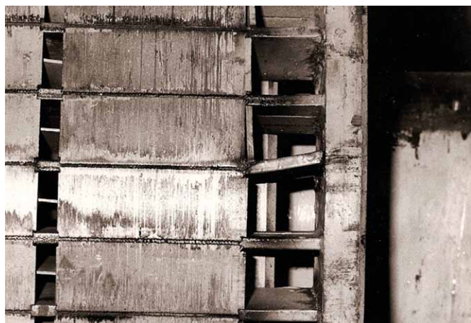
Rys. 13. Odgięte siłą bezwładności nagrzane pręty przy rewersie
