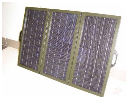
Rys. 7. Rozłożona bateria fotowoltaiczna dla stanowiska kamery bezobsługowej
