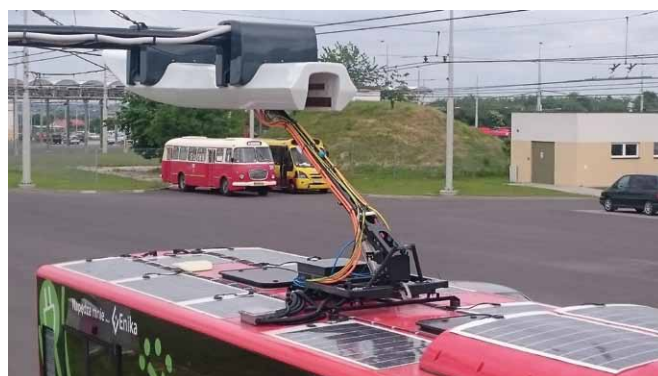
Rys. 9. Fotografia stanowiska ładowania z pantografu o prądzie maksymalnym 1000 A
