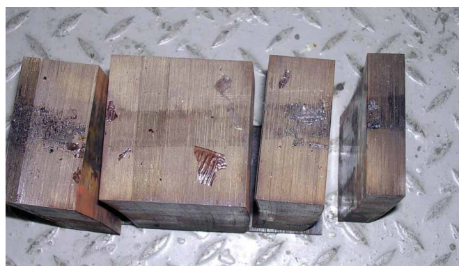
Rys. 7. Zniszczone mocowanie rdzenia i przesunięte fragmenty rdzenia
