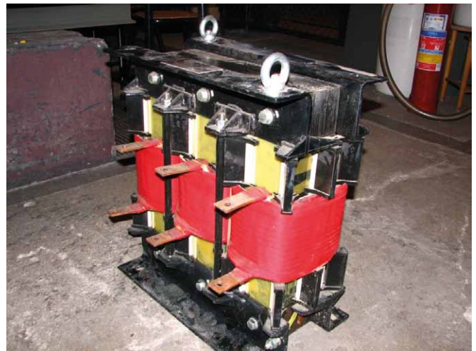
Rys. 4. Nowy dławik trójfazowy
