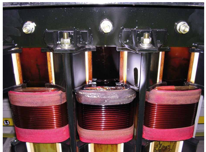
Rys. 5. Przegrzane uzwojenie i rdzeń dławika
