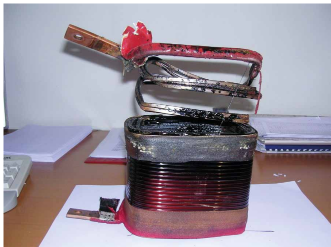
Rys. 6. Przegrzana cewka uzwojenia
