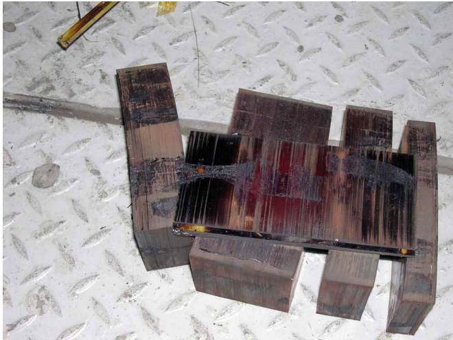
Rys. 8. Przegrzana osłona rdzenia
