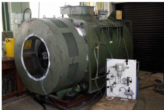
Rys. 4. Silnik w osłonie gazowej z nadciśnieniem na stanowisku badawczym
