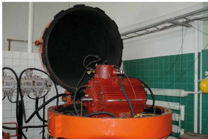
Rys. 2. Silnik w osłonie ognioszczelnej na stanowisku badawczym
