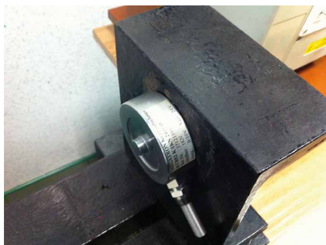
Rys. 4. Czujnik siły zamontowany na stanowisku pomiarowym liniowego silnika tubowego [opracowanie własne]
