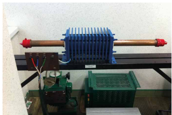
Rys. 2. Indukcyjny silnik tubowy skonstruowany w Zakładzie Maszyn Elektrycznych Politechniki Warszawskiej
