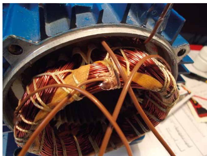
Rys. 14. Miejsca zainstalowania termopar wewnątrz maszyny
