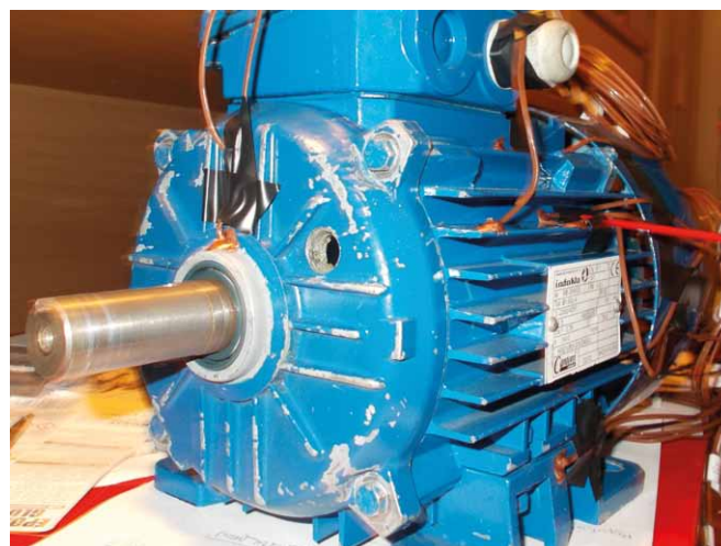
Rys. 15. Miejsca zainstalowania termopar na zewnątrz maszyny
