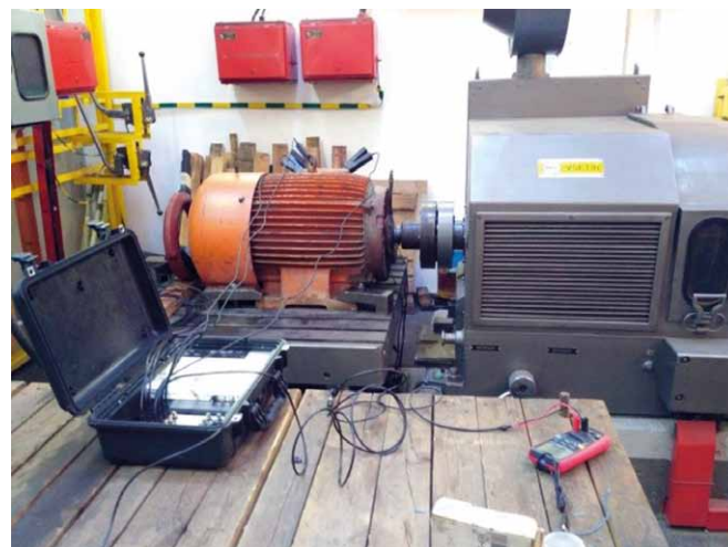
Rys. 3. Silnik obciążony na stanowisku w stacji prób
