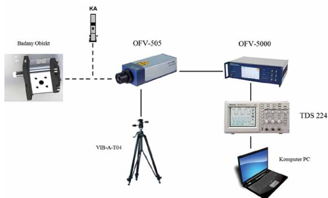
Rys. 2. Schemat układu pomiarowego: Badany Obiekt – pompa zębata 3PWR-SE-32/28; KA – kalibrator pomiarowy; B&K; OFV-505 – głowica laserowa; VIB-A-T04 – statyw; OFV-500 – kontroler; TDS 224 – oscyloskop cyfrowy czterokanałowy; Komputer PC – komputer PC IBM
