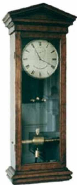
Fot. 3. Jeden z pierwszych zegarów pierwotnych Baina, w którym zastosowano kontakt elektryczny do przesyłania sekundowych sygnałów do zegarów wtórnych Źródło: [6]
