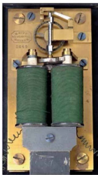
Fot. 7. Jedno z rozwiązań elektrycznych zegarów wtórnych (bocznych) Matthäusa Hip- pa pochodzące z roku 1890 Źródło [10]
