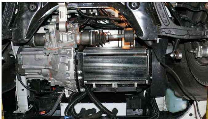
Rys. 3. Napęd pojazdu Fiat Panda 2 z falownikiem IGBT
