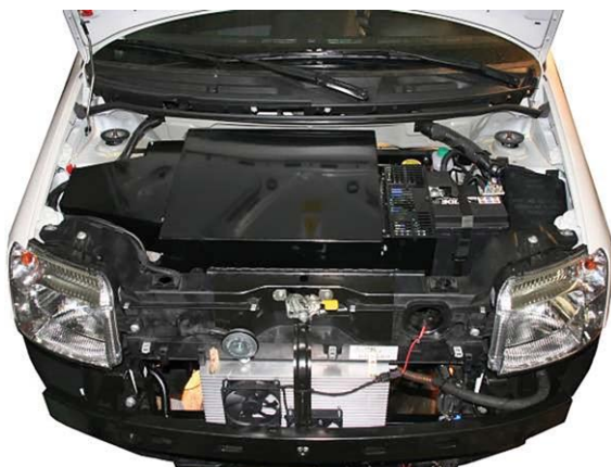
Rys. 1. Widok komory silnika Fiat Panda 2 z elektrycznym układem napędowym
