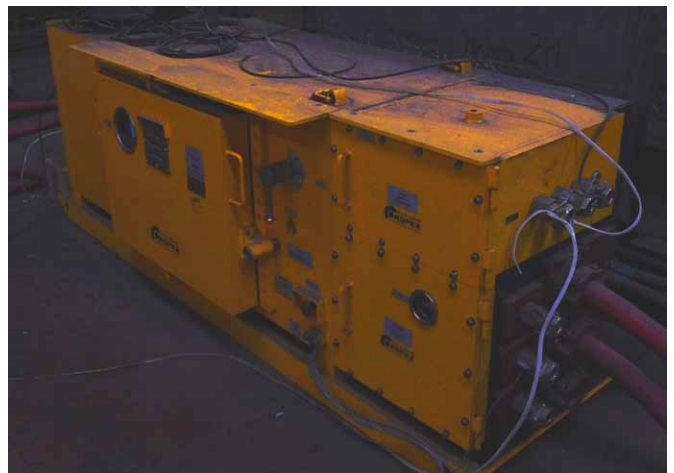
Rys. 4. Jeden z przekształtników częstotliwości zastosowanych na stanowisku badawczym
