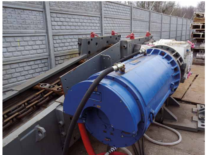
Rys. 3. Silnik napędowy przenośnika zgrzeblowego
