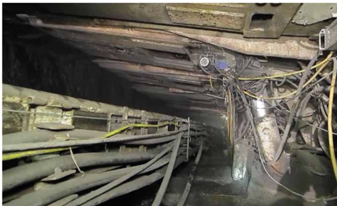
Rys. 1. Ścianowy przenośnik zgrzeblowy jako element kombajnowego kompleksu wydobywczego
