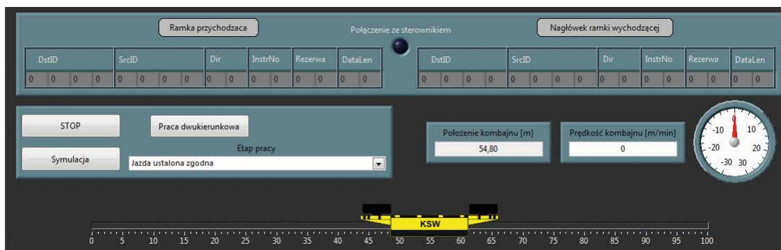
Rys. 5. Okno symulatora kombajnu ścianowego
