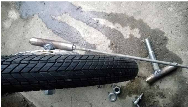
Rys. 6. Prototyp zwrotnicy, widoczny dodatni promień zataczania
