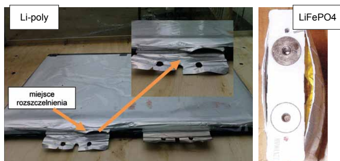
Rys. 4. Widok ogniwa po zakończonej próbie [2, 3]
