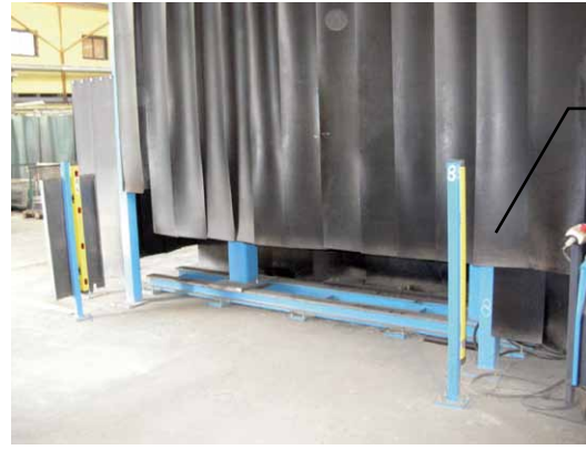
Fot. 3. Nieprawidłowo zainstalowana kurtyna świetlna
