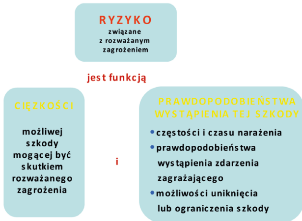
Rys. 2. Ilustracja definicji ryzyka (wg PN-EN ISO 12100:2012P) [18]
