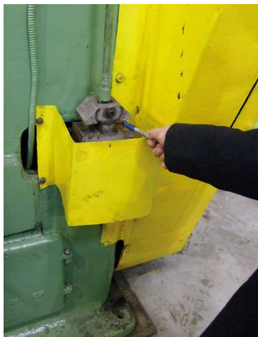
Fot. 5. Prasa PMS 100 – osłona nie speł- niająca funkcji ochronnej
