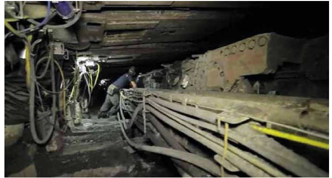
Rys. 1. Kombajnowy kompleks wydobywczy w KWK „Murcki-Staszic”
