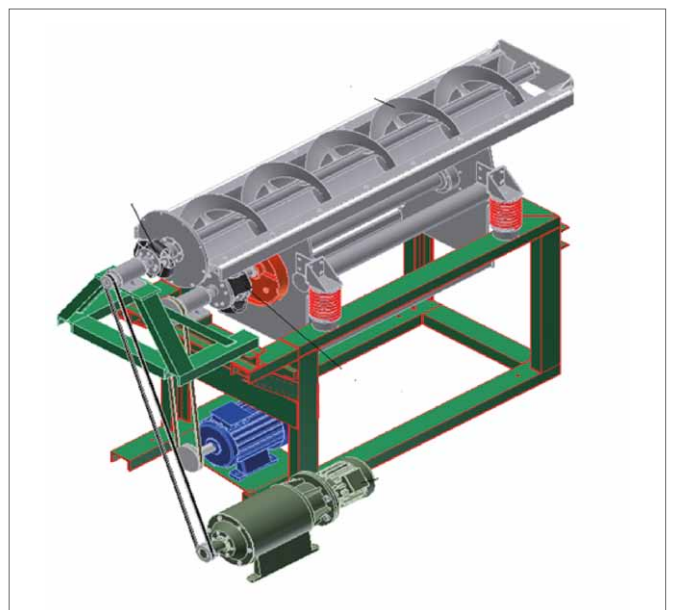
Rys. 5. Rynnowy grudkownik wibracyjny
