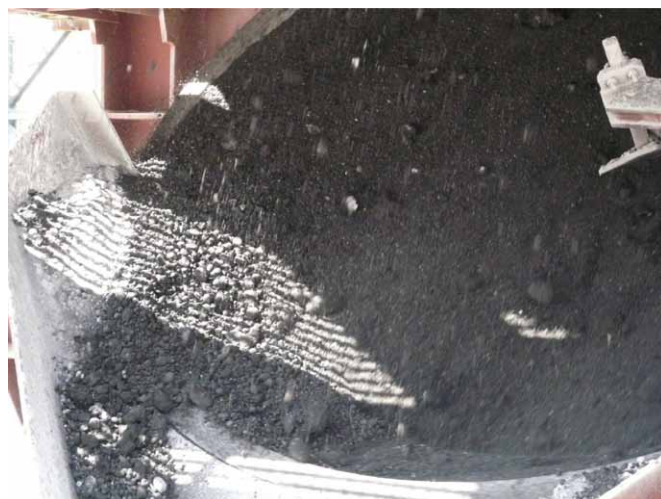
Rys. 7. Ruch materiału na granulatorze talerzowym
