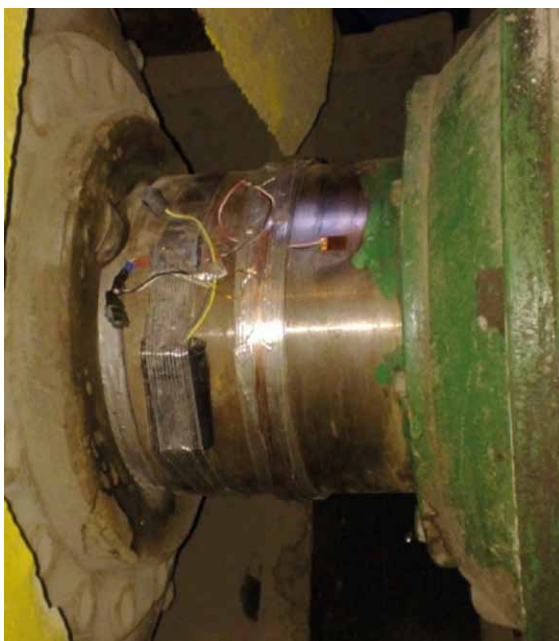
Rys. 5. Układ tensometryczny zamontowany na wale badanego silnika
