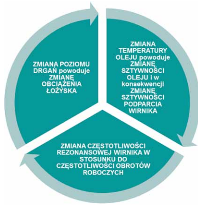
Rys. 2. Możliwe wzajemne uzależnienia między zmianami temperatur i drgań
