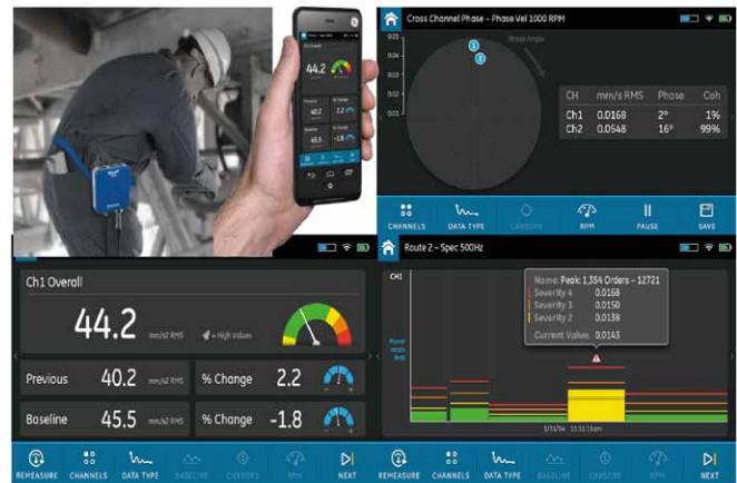
Rys. 3. Przenośny zbieracz i analizator sygnałów nowej generacji oraz przykłady wybranych ekranów
