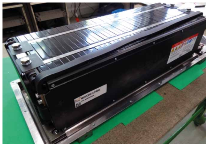
Rys. 4. Moduł baterijny A123 z ogniwami pryzmatycznymi Li-ion nanofosfatowymi, o pojemności 5 kWh
