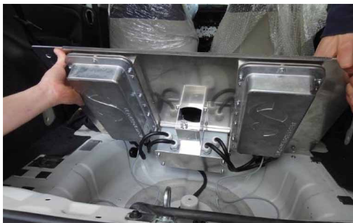
Rys. 5. Ładowarki baterii trakcyjnej zamontowano w przestrzeni koła zapasowego. Zastosowano dwie ładowarki o łącznej mocy 6 kW
