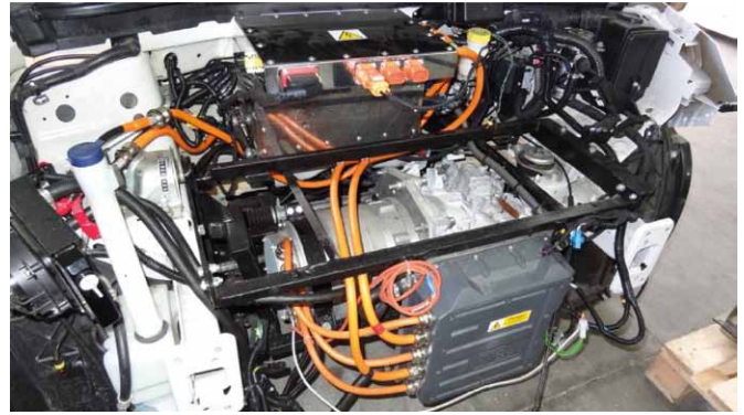
Rys. 2. Falownik energoelektroniczny zamontowany w samochodzie osobowym, za nim widoczny silnik IPMSM i skrzynia biegów
