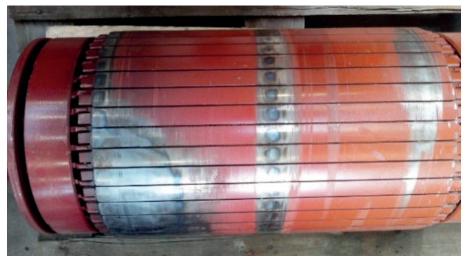
Fot. 4. Wirnik uszkodzonego silnika
