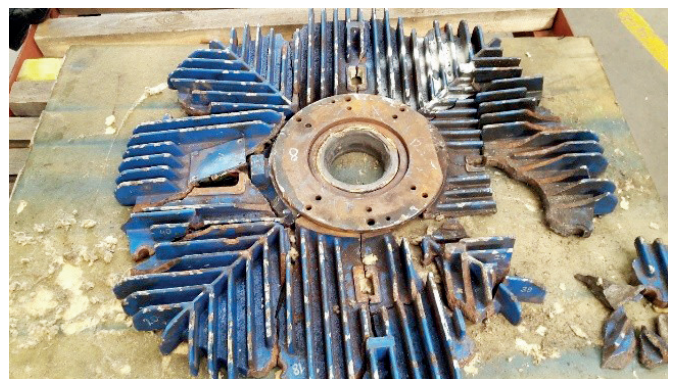
Fot. 2. Fragmenty tarczy łożyskowej od strony napędowej
