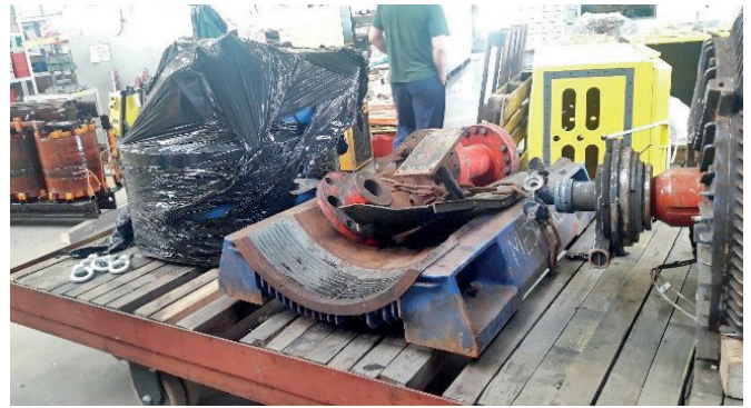
Fot. 1. Łapy silnika oderwane od pozostałej części korpusu
