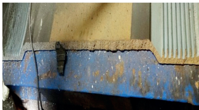
Fot. 7. Oddzielone łapy od pozostałej części korpusu silnika.
