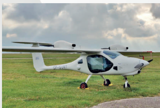
Silnik LEMoK 300 wykorzystany został do napędu hybrydowego, lekkiego statku powietrznego o masie startowej do 750 kg
