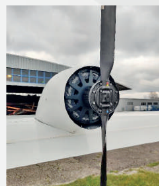
Silnik LEMoK 300 wykorzystany został do napędu hybrydowego, lekkiego statku powietrznego o masie startowej do 750 kg
