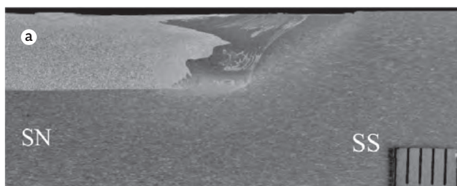
Rys. 8. Makrostruktury obszaru zgrzewania w wybranych narożnikach złącza. SN – strona natarcia, SS – strona spływu. Traw. Keller
