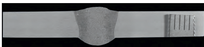
Rys. 7. Makrostruktura spawanego hybrydowo złącza doczołowego blach o grubości 5 + 5 mm
