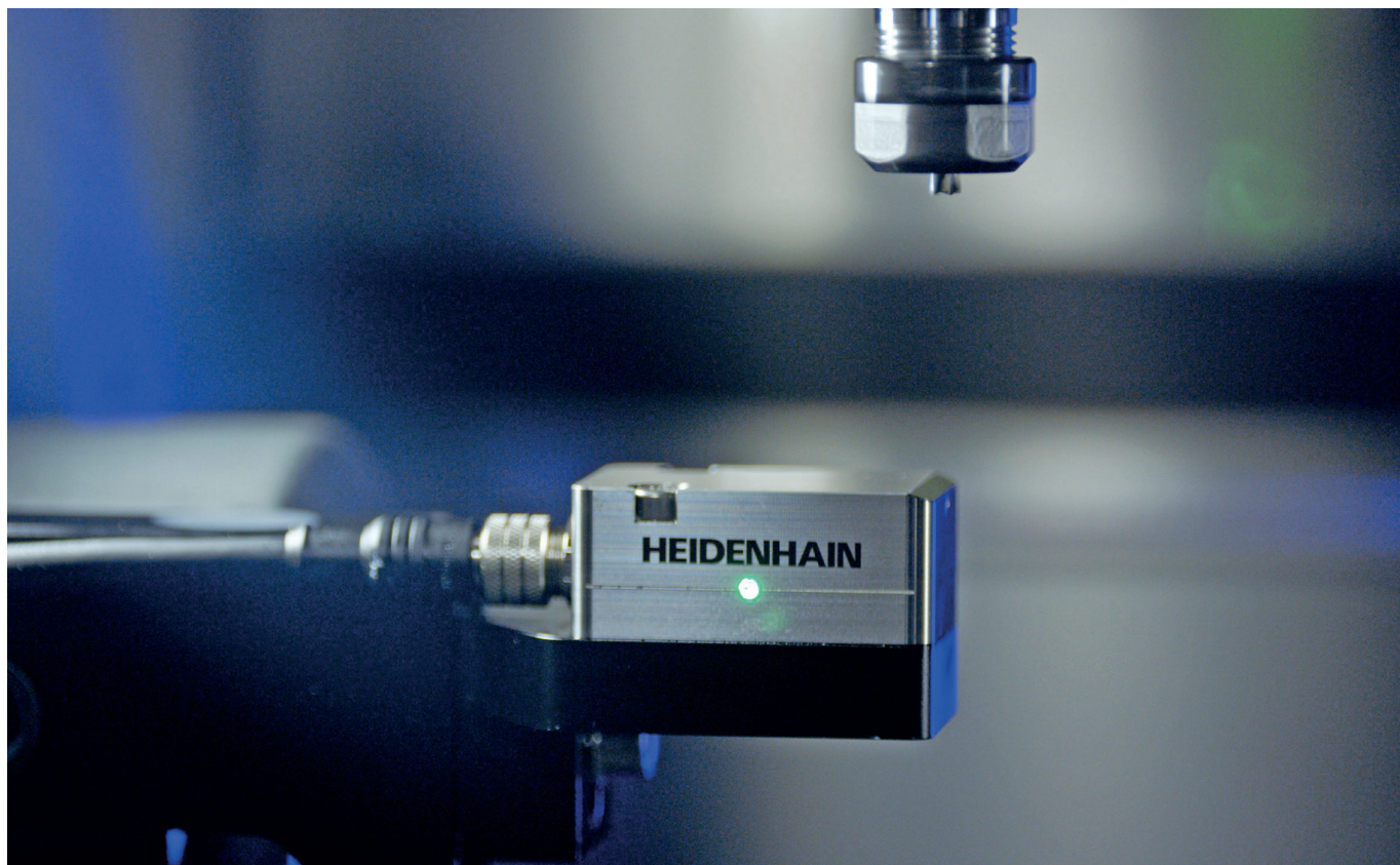
TD 110 wykrywa złamanie nawet najmniejszego narzędzia bez opuszczania obszaru pracy, przy włączonych obrotach i szybkim posuwie
