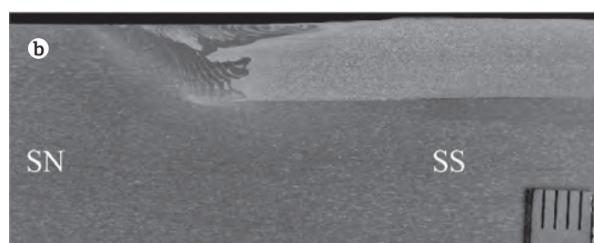
Rys. 8. Makrostruktury obszaru zgrzewania w wybranych narożnikach złącza. SN – strona natarcia, SS – strona spływu. Traw. Keller
