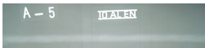
Rys. 6. Radiogram złącza doczołowego 5 + 5 mm wykonanego metodą HLAW
