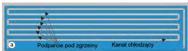
Rys. 7. Schemat budowy korpusu z kanałem chłodzącym (a) oraz widok kadłuba po procesie zgrzewania FSW (b)
