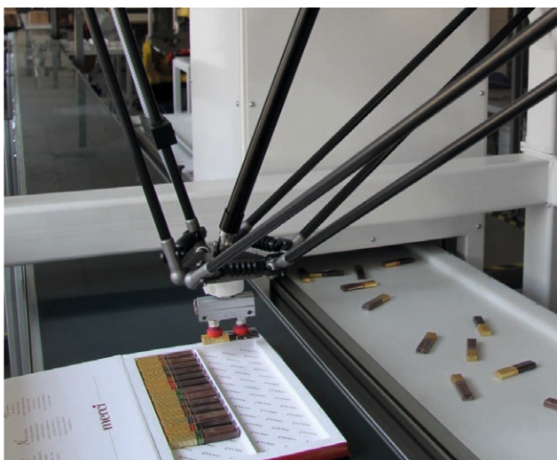
↑ Rys. 16. Robot IRB360 układający czekoladki w kartonie
