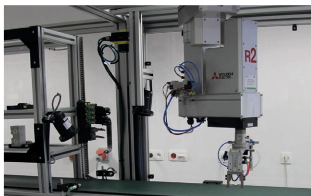
↑ Rys. 13. Robot SCARA RH-3FHR firmy Mitsubishi na stanowisku roboczym
