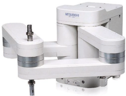
↑ Rys. 14. Robot SCARA RP-firmy Mitsubishi Electric
