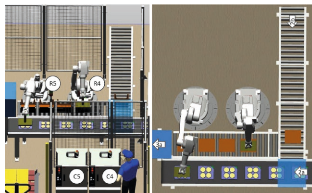
↑ Rys. 22. Stacja pakowania w środowisku RobotStudio firmy ABB: R4, R5 – roboty IRB1600; C4, C5 – kontrolery IRC5 z panelami nauczania (Flex Pendantami); 2a, 2b – transporterzy dosyłające produkty; 3a – transporter wyjściowy
