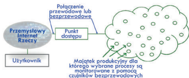
Rys. 1. Grupa czujników bezprzewodowych podłączona do Przemysłowego Internetu Rzeczy
