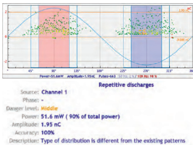
Rys. 3. Obraz wykładowań otrzymany przy pomocy czujnika TEV oraz ocena ekspercka
