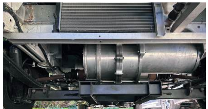
Rys. 13. Zdjęcie zabudowanego zespołu napędowego na ramie samochodu
