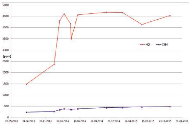
Rys. 9. Stężenie wodoru i metanu w oleju tr. 63 MVA na przestrzeni 5 lat
