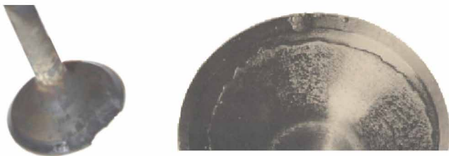
Rys. 8. Przykłady uszkodzenia zaworu wynikającego z obecności nagaru
