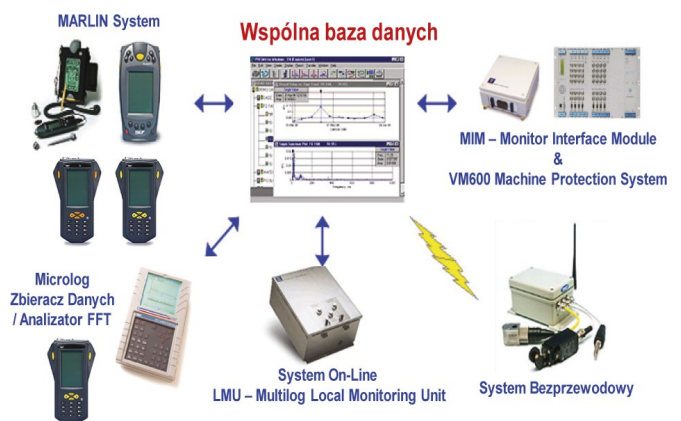
Rys. 13. Uproszczony schemat ideowy zintegrowanego systemu diagnostyki w danym zakładzie przemysłowym, rozbudowany o bezprzewodowy przekaz sygnałów wg. SKF [4]
