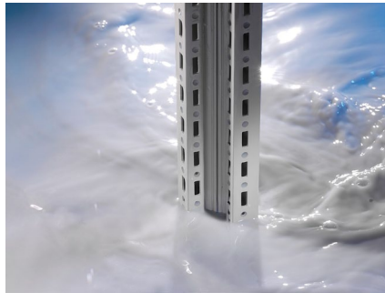
Gruntowanie zanurzeniowe stelaży ramowych do szaf sterowniczych w zakładach Rittal w Rittershausen
