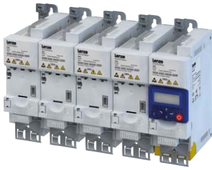
Montaż książkowy przemiennika i500 (0 mm odstępów) bez spadku mocy
