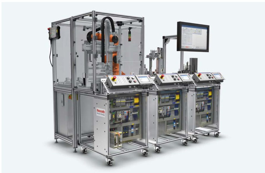
Mechatroniczne stanowisko dydaktyczne mMS 4.0 umożliwia montaż kostek na linii składającej się z trzech stanowisk roboczych: magazynu półproduktów, prasy pneumatycznej lub hydraulicznej i magazynu wysokiego składowania
