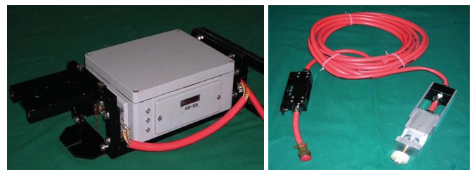
Fot. 2. Jednostka główna (z lewej) oraz jednostka zewnętrzna (z prawej) specjalnej aparatury do pomiaru metodą dynamiczną [11] naprężeń zmiennych doznawanych przez cięgła nośne składowego podczas jego jazdy w szybie
