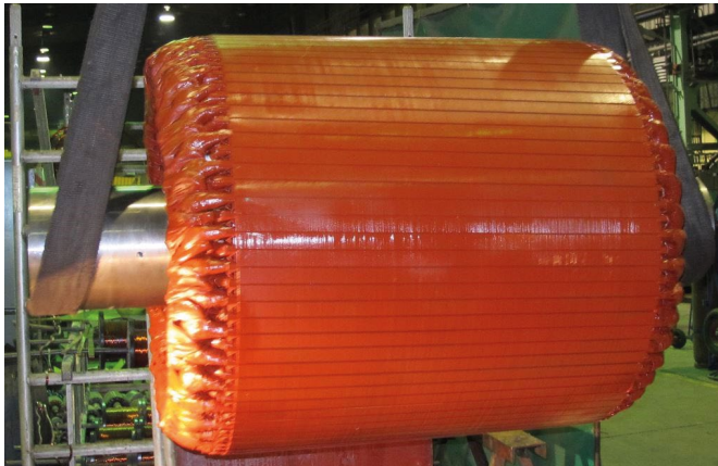
Rys. 2. Uzwojony pakiet stojana silnika PMSM
