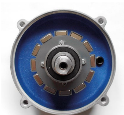
Rys. 3. Wirnik z 12 zagłębionymi magnesami i tarczą łożyskową
