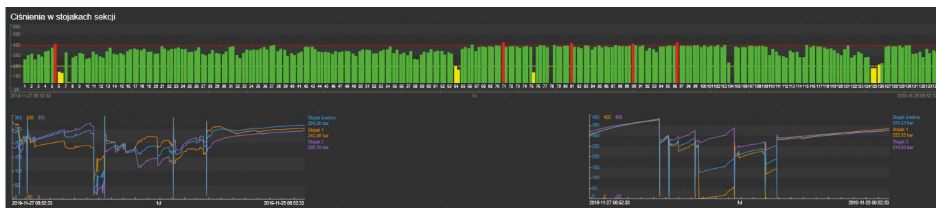
Rys. 4. Wizualizacja podporności sekcji obudów zmechanizowanych
