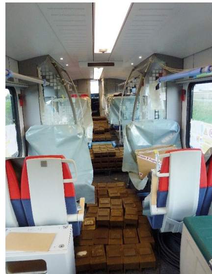
Rys. 3. Elektryczne zespoły trakcyjne obciążane balastem podczas badań właściwości trakcyjnych
