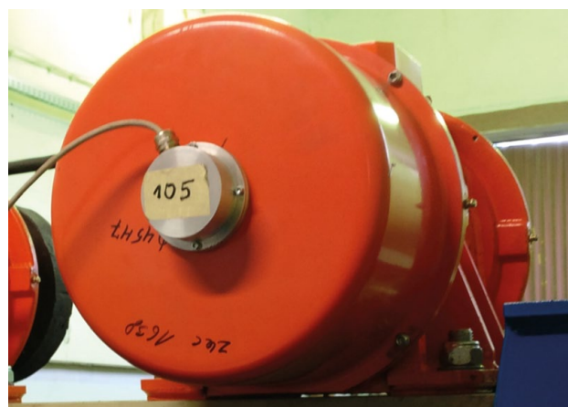
Rys. 5. Sposób zamocowania enkodera inkrementalnego dla modelowego silnika SMwsK112S6
