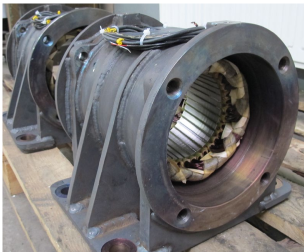
Rys. 2. Uzwojony twornik silnika SMwsK112S6 osadzony w korpusie stalowym spawanym
