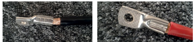
Rys. 12. Wyniki badania wytrzymałościowego złącz
