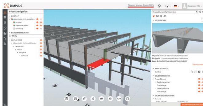
Rys. 5. Przykładowy model konstrukcji prefabrykowanej na platformie Bimplus [59]
